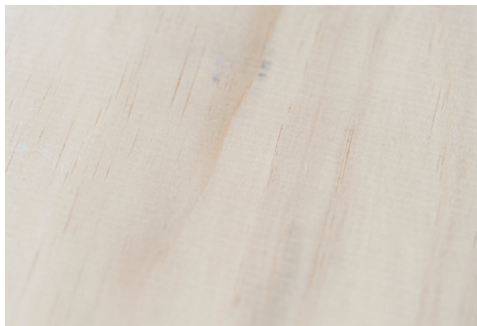
Accoya bleicht bei der Modifikation fast völlig aus, eine konsistente Farbgebung bei der Oberflächenbehandlung wird so erleichtert
