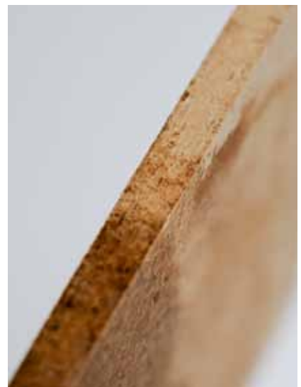
Nach einer Woche zur Hälfte unter Wasser zeigt das Accoya MDF keine Aufquellung.
