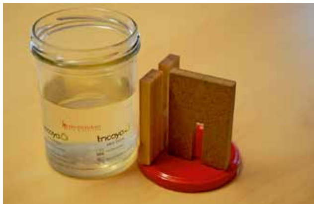
Tricoya weist selbst nach einer Wasserlagerung eine hohe Maßhaltigkeit auf. Die ineinandergeschobenen Teile können wieder getrennt werden
